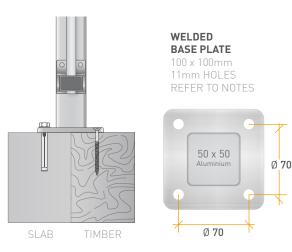
FLANGED (ON SLAB) POST DETAIL
