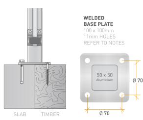
FLANGED (ON SLAB) POST DETAIL
