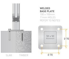
FLANGED (ON SLAB) POST DETAIL
